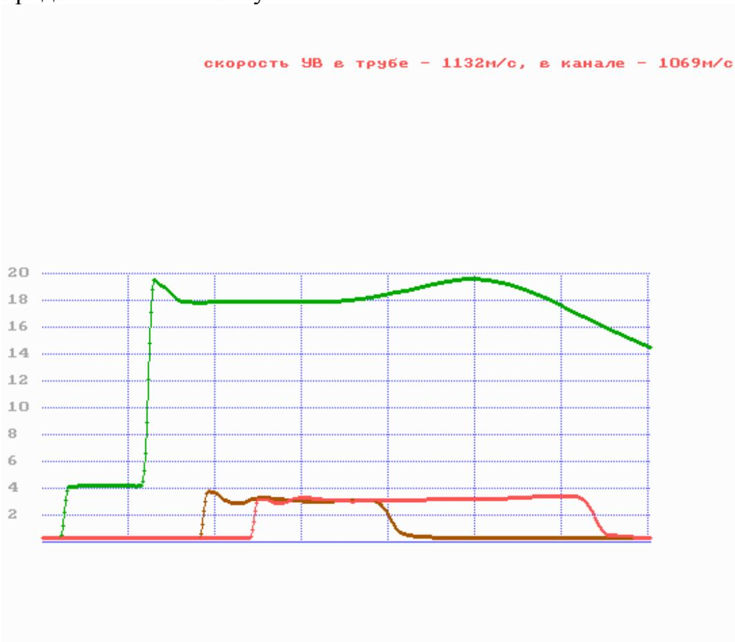
Рис. 6.4. Временные зависимости  $I$  давления в местах расположения датчиков в КНД и МГД-канале.
