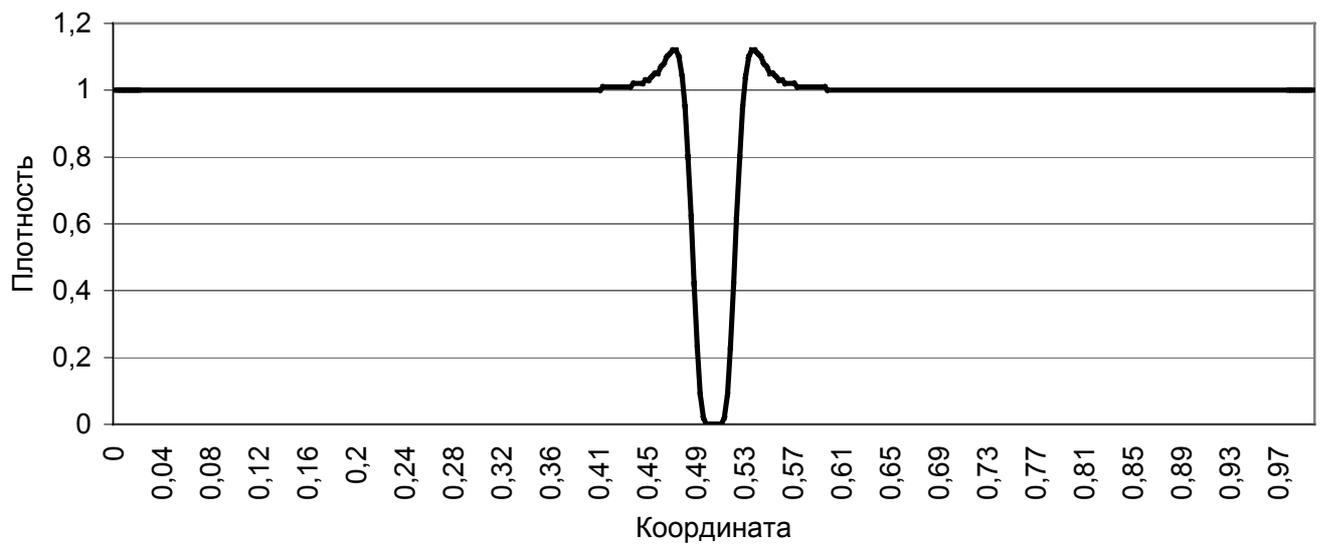
Рис. 2.2. Разрез поля плотности через центр источника
