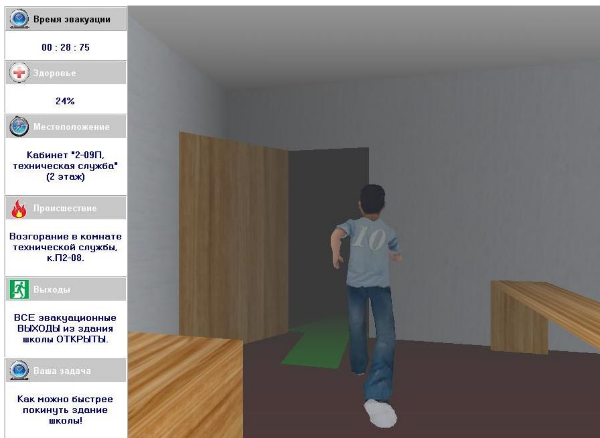
Рисунок 1 – Интерактивное 3D моделирование эвакуации учащихся из здания школы с учетом распространения задымленности помещения
