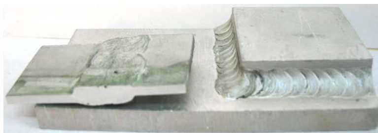
Рисунок 4 – Образцы, вырезанные из объемной конструкции летательного аппарата, сваренной из листового из сплава АМгб с помощью прутков, содержащих НП
