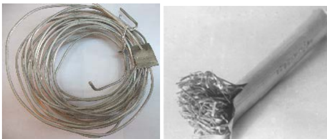
Рисунок 2 – Слева: бухта прутка \varnothing 9,5 мм, отпрессованного из частиц алюминия и нанопорошков, служащего в качестве средства для введения НП в металлические расплавы, а также в качестве сварочного электрода; Справа: внутреннее строение прутка \varnothing 9,5 мм, отпрессованного из алюминиевых гранул и НП
