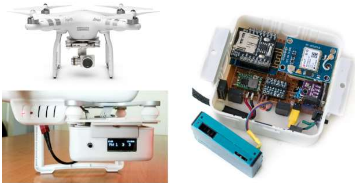
Рисунок 3 – Внешний вид прибора для измерения характеристик атмосферы на базе квадрокоптера и его отдельных элементов.
