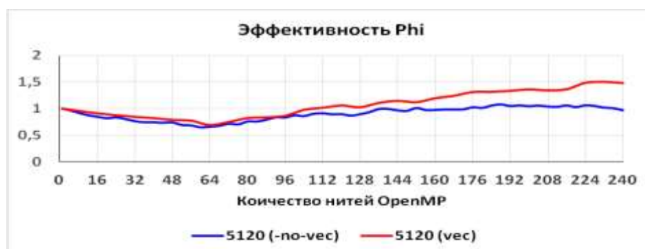
Рисунок 7 – Эффективность параллельной версии решения СЛАУ относительно последовательной реализации для параллельного (no-vec) и векторно-параллельного (vec) кода
