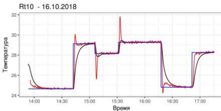
Рисунок 13 – Результат предсказания для датчика Rt10, расположенного на нагревателе: синяя линия – температура стационарного состояния, черная кривая – фактическая температура показаний датчика, красная линия – результат онлайн-прогноза температуры устойчивого состояния
