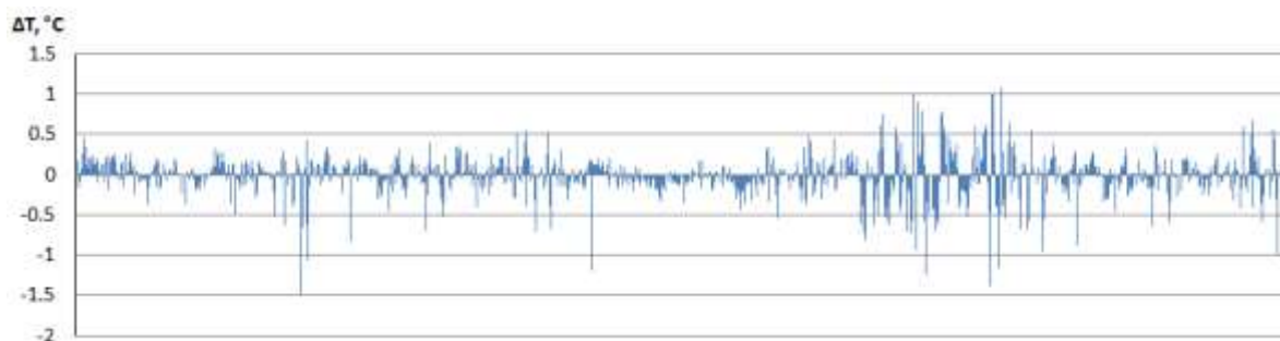
Рисунок 10 – Отклонение расчетных температур от термограмм силового блока
