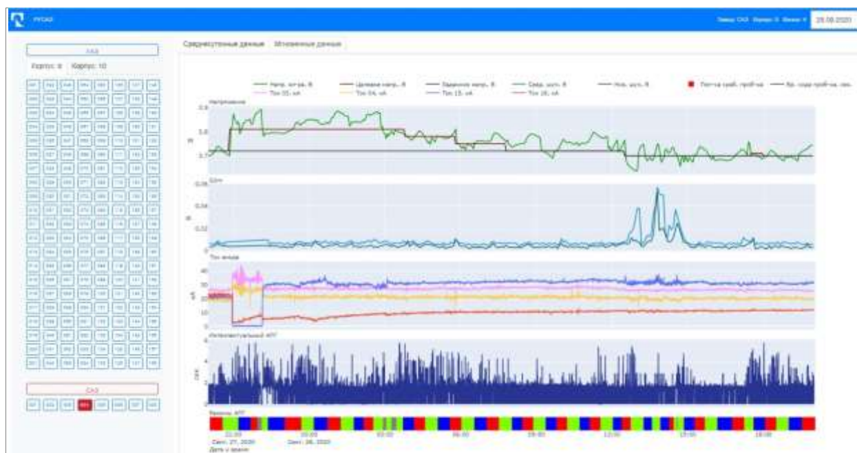
Рис. 1.5 – Средства оперативного контроля технологических параметров в цикле производства алюминия с индикацией обнаружения отклонений
