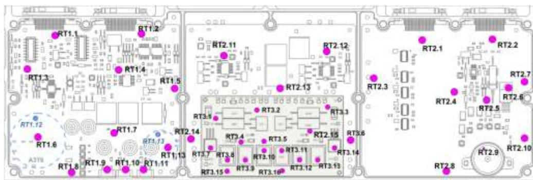
Рис. 1.13. Схема модуля и расположение температурных датчиков.
