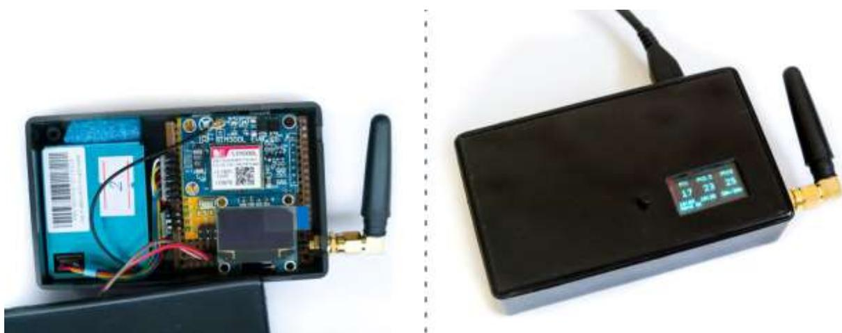
Рисунок 21 – Прибор для измерения концентрации взвешенных частиц PM2.5 в воздухе.
