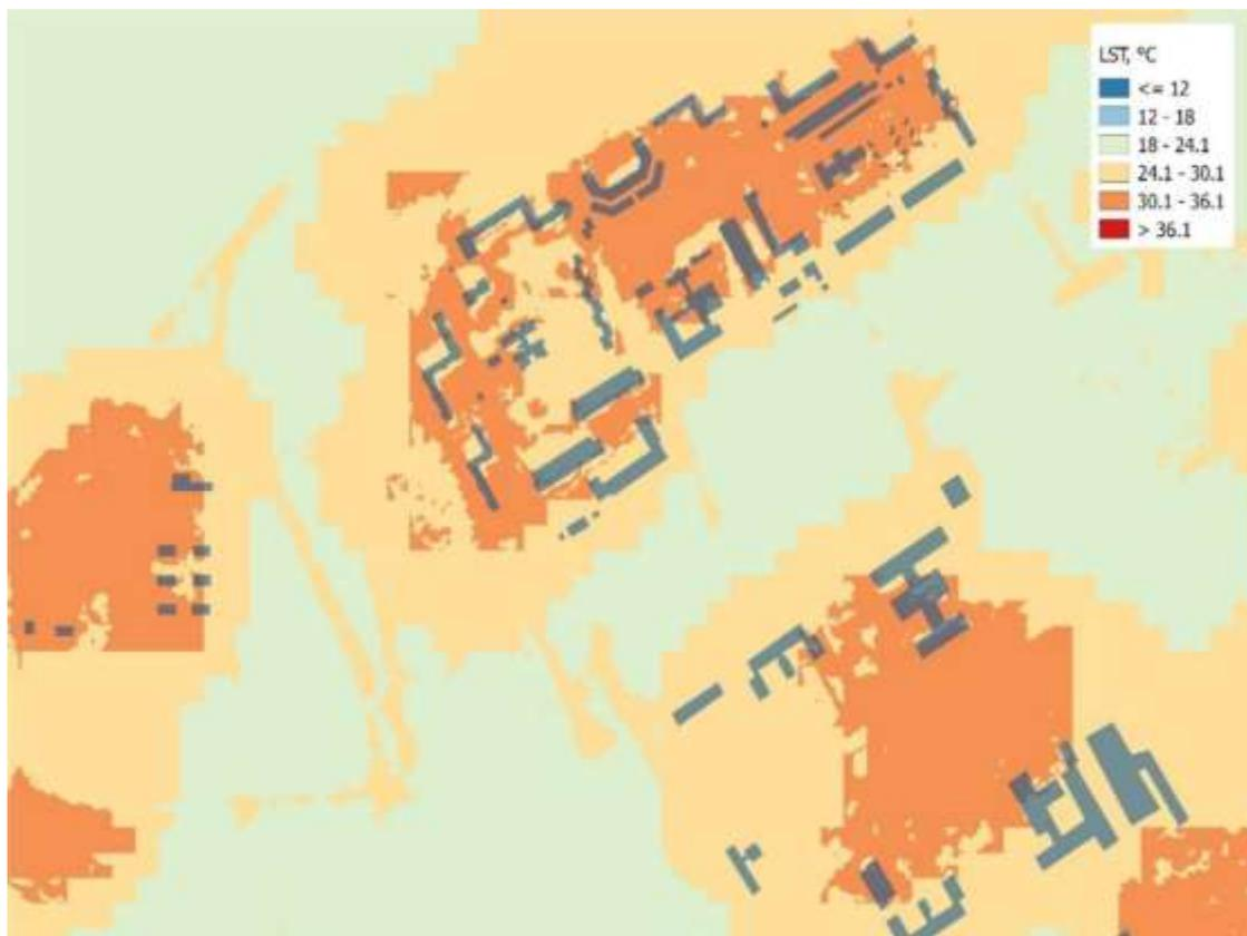
Рисунок 10. Комбинация данных теплового ИК-диапазона Landsat-8 с используемыми для вычисления NDVI данными PlanetScore позволяют получить детальную тепловую карту уровня отдельных городских кварталов.
