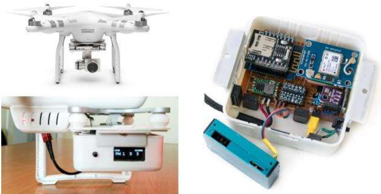
Рисунок 22 – Внешний вид прибора для измерения характеристик атмосферы на базе квадрокоптера и его отдельных элементов.
