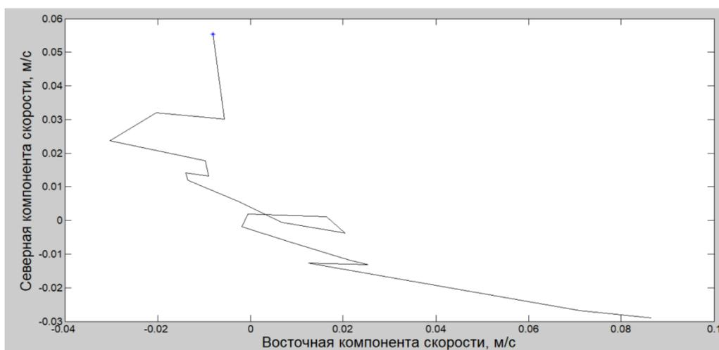
Рисунок 9 – Годограф (м/с) для горизонтальной скорости по измерениям ADCP 600 kHz в период 17.06.2014 – 20.06.2014
