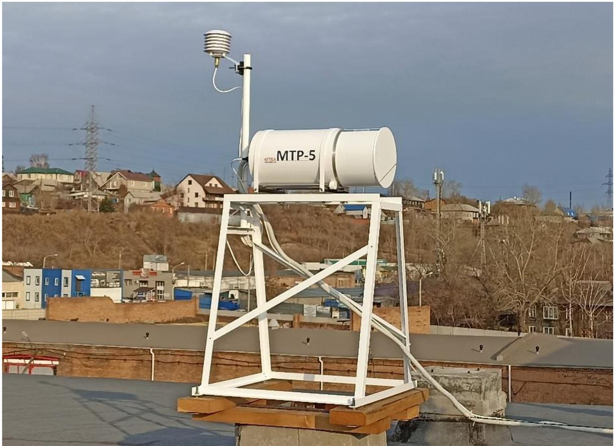
Рисунок 19 – Метеорологический температурный профилемер МТР-5 в работе.
