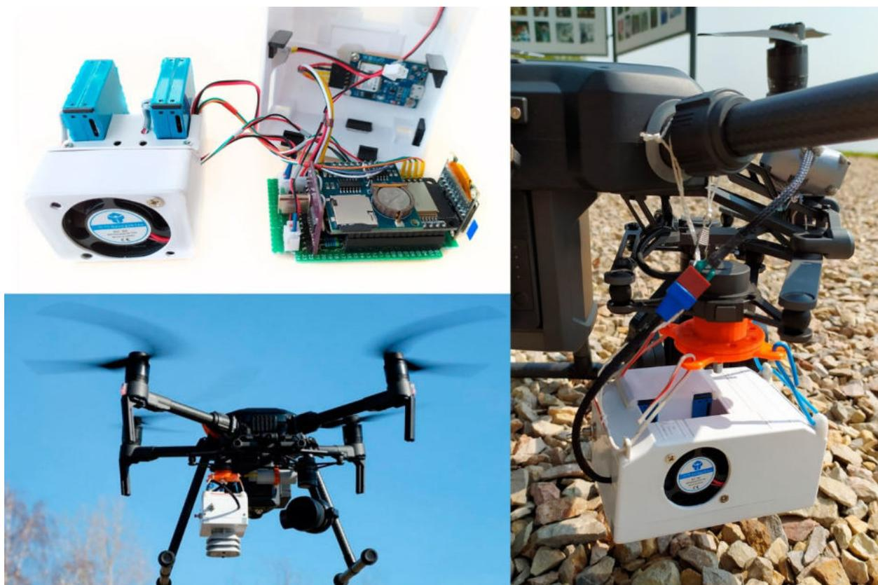
Рисунок 30 – Размещение прибора на квадрокоптере DJI Matrice 210.
