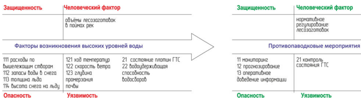
Рисунок 69 – Концептуальная схема управления риском возникновения чрезвычайных ситуаций, связанных с затоплением территорий.
