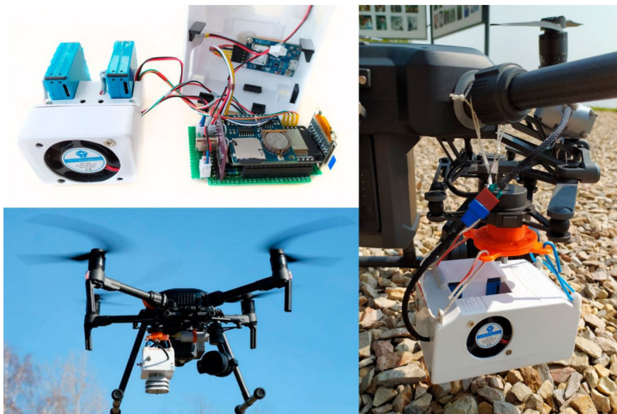
Рисунок 51 – Размещение прибора на квадрокоптере DJI Matrice 210.
