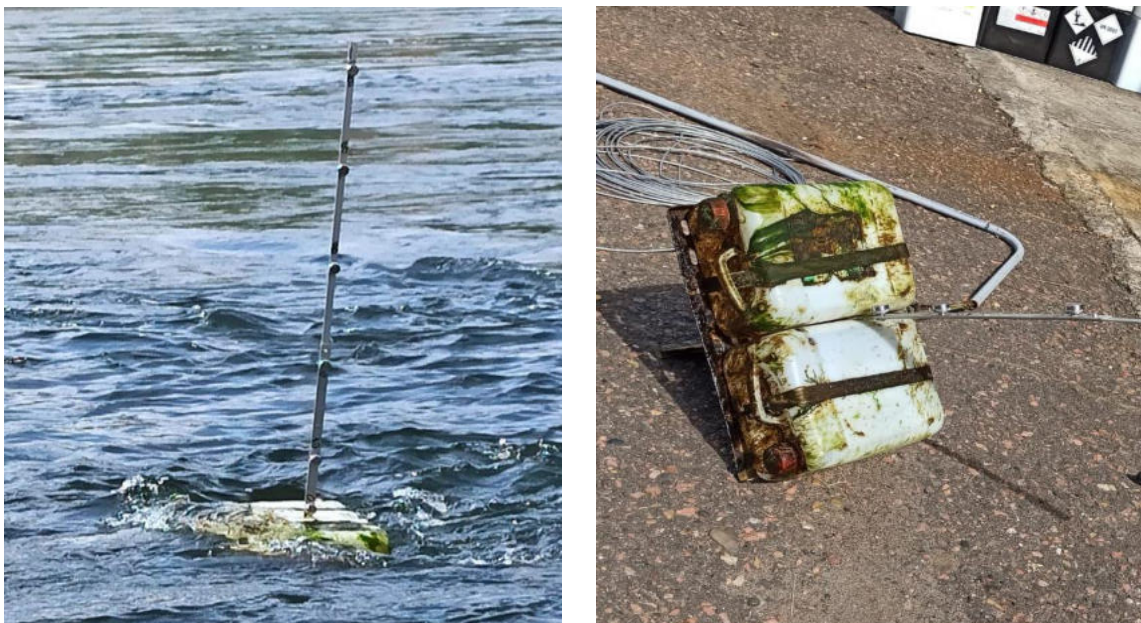
Рисунок 5 – Внешний вид «термокосы плавающей», прикрепленной к пирсу на расстоянии 500 м от плотины (слева) и ее киля-«поплавка» (справа), на котором были установлены дата-логгеры для измерения температуры воды
