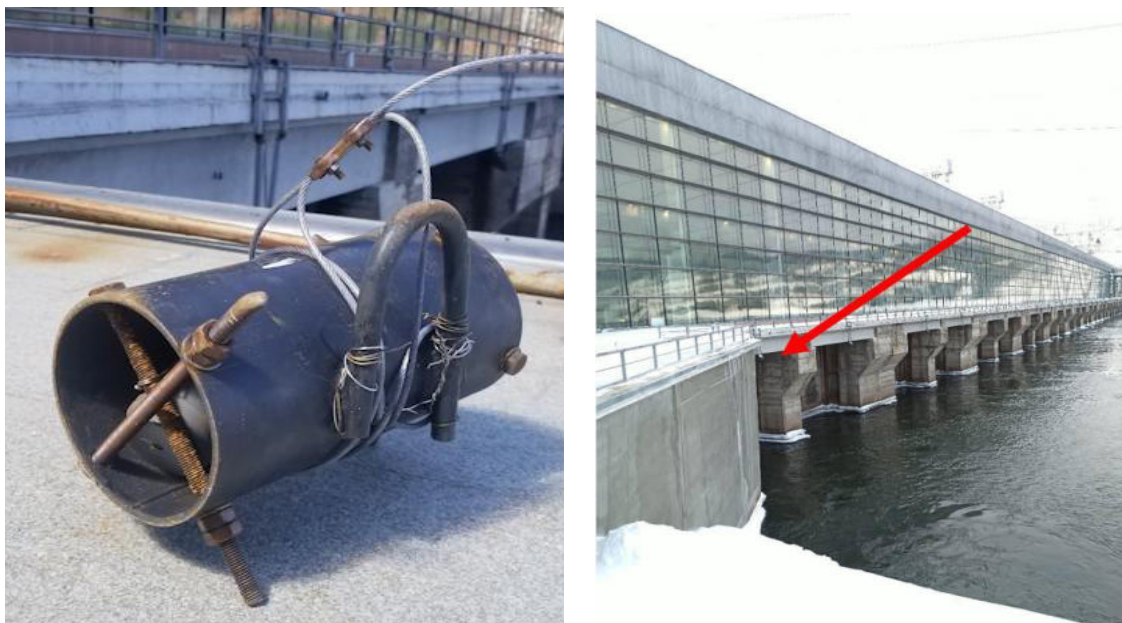
Рисунок 4 – Защитный корпус для дата-логгеров на стальном тросе толщиной 1 см и место его установки на пирсе рядом с плотиной Красноярской ГЭС
