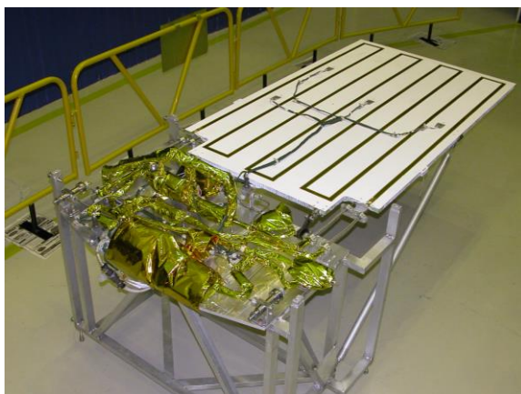
Рисунок 1 – Опытный образец системы терморегулирования спутника на базе контурной тепловой трубы с раскрывающимся радиатором
