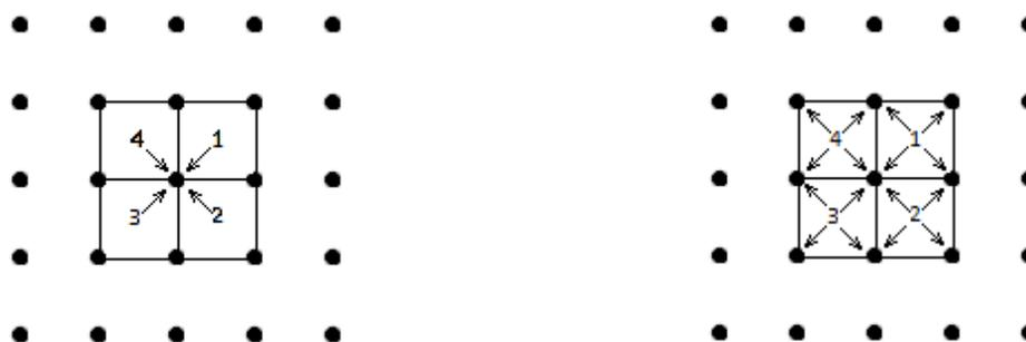
Рисунок 9 – Схема сборки невязки по узлам сетки (слева) и по элементам (справа)
